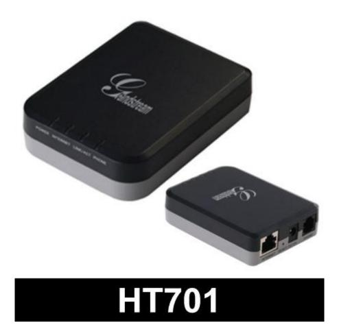
O HT-701 é um Adaptador de telefone analógico com 1 porta FXS, comporta uma conta SIP e uma portas de rede.
