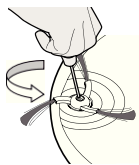
Parafuse a escova lateral esquerda em sentido anti-horário
