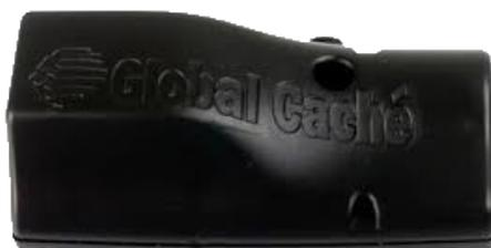
Vamos conectar um cabo de rede no iTach Flex IP conectando-o a nosso roteador para que possamos encontra-lo em nossa rede, por padrão de fábrica ele já vem como DHCP.
