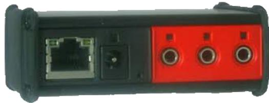
Vamos conectar um cabo de rede no iTachIP2IR conectando-o ao nosso roteador para que possamos encontra-lo em nossa rede, por padrão de fábrica ele já vem como DHCP.
