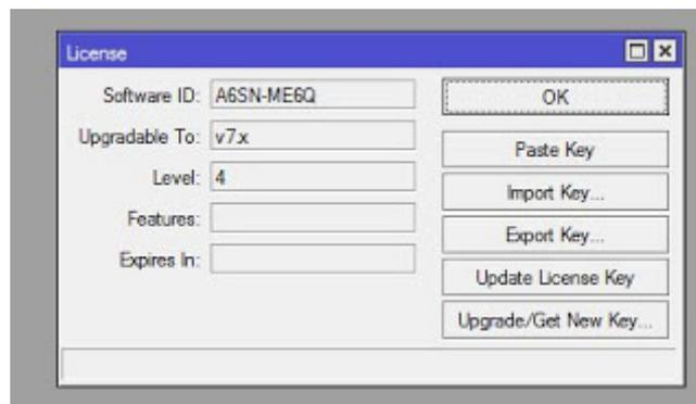
Trata-se de um código que é gerado pelo sistema exclusivo para o dispositivo de armazenamento onde o RouterOS está instalado, ou seja, o HD, Flash Disk, Pendrive, etc, e também é exclusivo para a partição onde o sistema fica.
